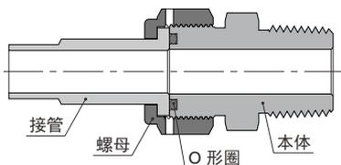
2. 将接头本体牢牢固定，用扳手拧螺母 1/8-1/4 圈，直到拧动力矩出现急剧升高为止。
