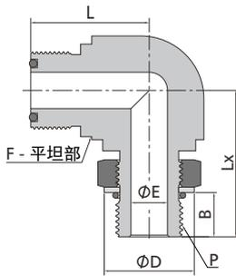
SAE/MS 阳螺纹可调弯头接头
